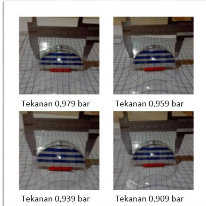
Gambar 14. Plastik 0,35 mm berbentuk setengah bola pada masing-masing suhu.
