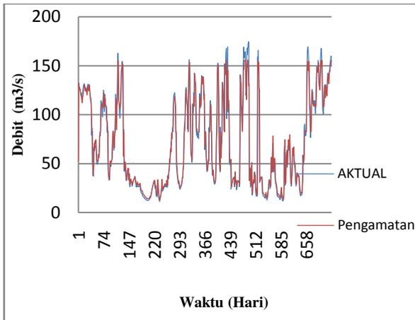
Gambar 4. Hasil Perbandingan Antara Debit Pengamatan dengan Debit Peramalan Model ANFIS untuk SKEMA 1.
