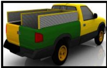
Gambar 4.11 *Pick Up* dengan bak terpilah
