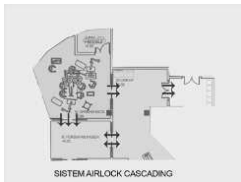
Gambar 2.20 Sistem airlock cascading pada ruang operasi
