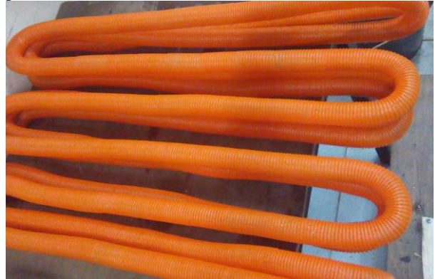
Gambar 5 Tube bagian luar evaporator
