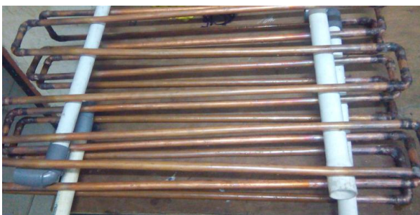
Gambar 4 Tube bagian dalam pada evaporator
