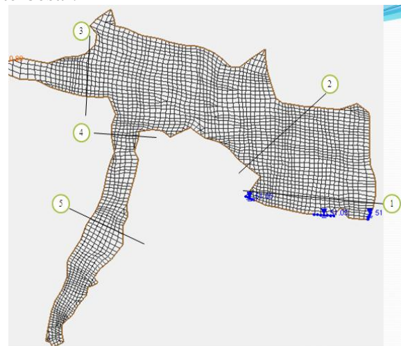
Gambar 10 Pemotongan mesh bendung uwai
