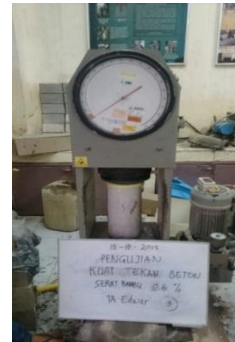
Gambar 2. Pengujian Kuat Tekan
