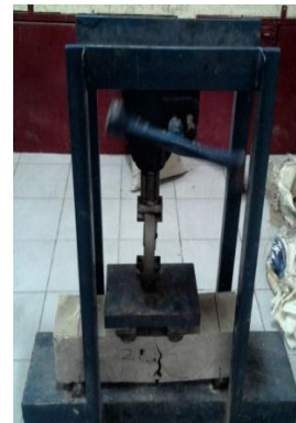
Gambar 7. Pengujian Kuat Lentur
