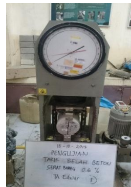
Gambar 3. Pengujian Kuat Tarik Belah
