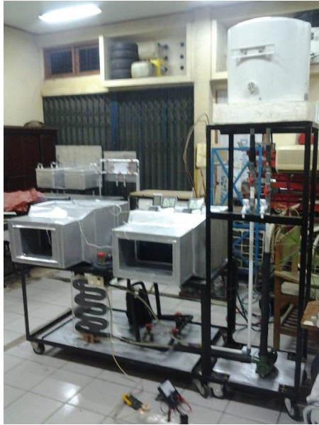
Gambar 3. Foto Alat Uji Mesin Pendingin Siklus Kompresi Uap Hibrida Dengan Katup Ekspansi Jenis Kapiler Dan Termostatik
