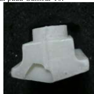
Gambar 10. Hasil Spesimen Pola Lilin
