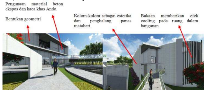
Gambar 3.34. : Fasad Fasilitas Pelayanan Umum Sumber : Hasil Pengembangan Desain, 2015
