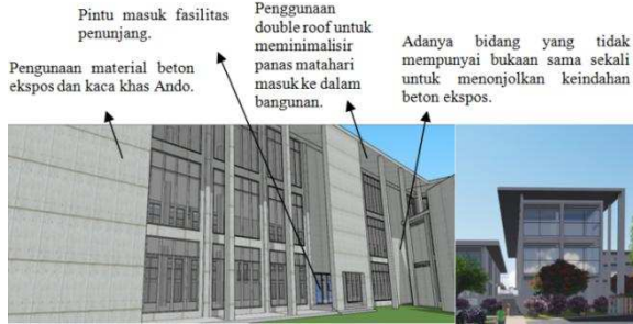
Gambar 3.38. : Fasad Fasilitas Penunjang Sumber : Hasil Pengembangan Desain, 2015
