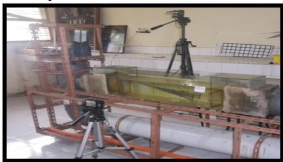
Gambar 4: Cara pengambilan data dengan kamera video di flume tank
