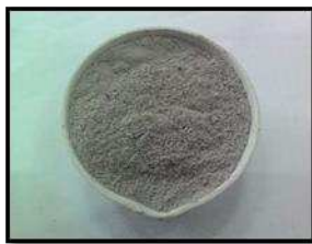
Gambar 1. Abu Sekam lolos Saringan no. 200 Sumber: Dokumentasi Penelitian, 2015
