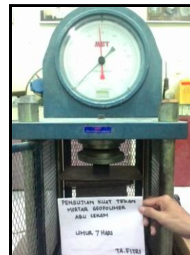
Gambar 2. Pengujian Kuat Tekan Mortar Sumber: Dokumentasi Penelitian, 2015
