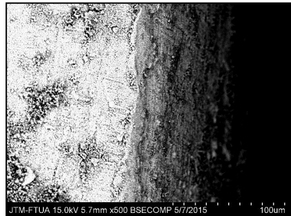
Gambar 2 Tampak lintang Stainless steel 316L yang telah dilapisi HA waktu pelapisan 17 menit dan tegangan listrik 40 dan 60 volt
