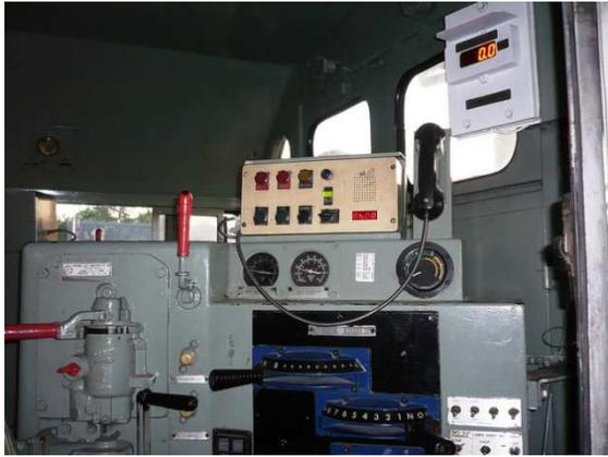
**Gambar 11. Panel Kontrol dan Display Lokomotif CC203**
