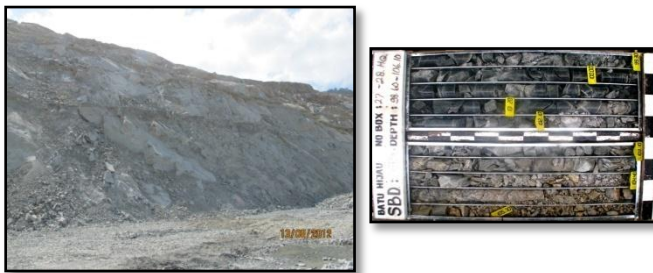
Gambar 5. Kondisi batuan Vulkanik penyusun lereng dinding Timur Laut
