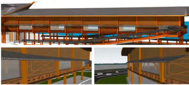
Gambar 2.10 Penghawaan Pasif Melalui Kisi - Kisi
