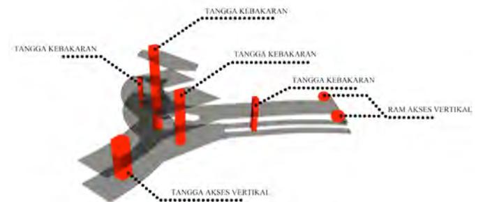
Gambar 2.6 Peletakan Tangga dan Akses Evakuasi Dalam Bangunan
