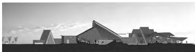
Gambar 2.24 Potongan Site dengan Peninggian Permukaan Tanah
