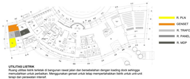
Gambar. 2.18 Sistem Utilitas Listrik
