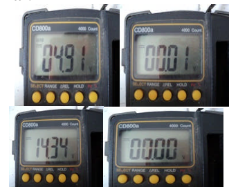
Gambar 3.4 display pengukuran motor dc menggunakan multitester digital
