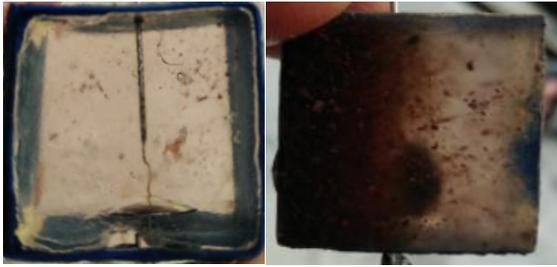
4.2 Gambar tembus listrik pada pengujian resin murni dan isolator epoxy campur bubuk cangkang kelapa sawit 0.5gr.
