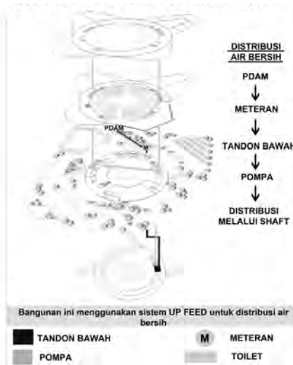
Gambar 2.12 Sistem Utilitas Air Bersih
