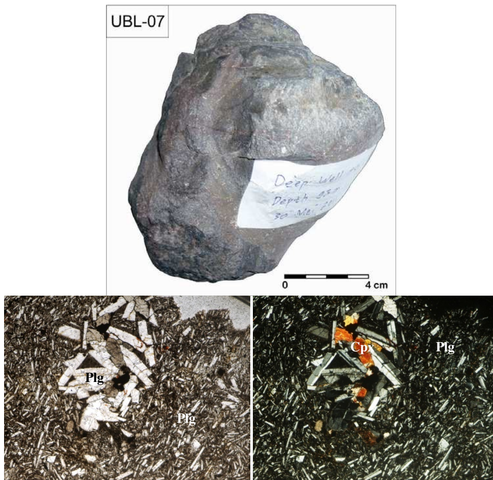
Gambar 12. Contoh setangan Basalt kode contoh UBL-07 (atas) dan contoh sayatan tipis (bawah). Gambar di sebelah kiri merupakan nikol sejajar sedangkan di sebelah kanan nikol bersilang, menunjukkan kelimpahan mineral plagioklas.
