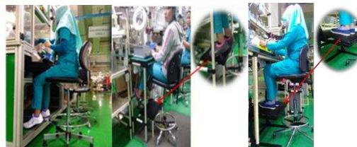
Gambar 13 Posisi duduk operator tidak menggunakan *Footrest* , menggunakan *Footrest* yang lama dan menggunakan *Footrest* yang baru
