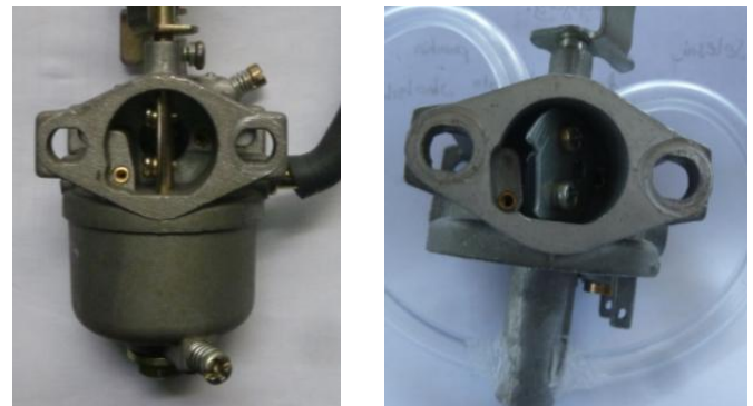
Gambar 1. Karburetor bensin (kiri) dan karburetor biogas (kanan)
