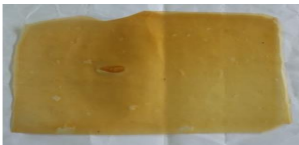
Gambar 2 Plastik biodegradable dengan massa tepung 5 gram
