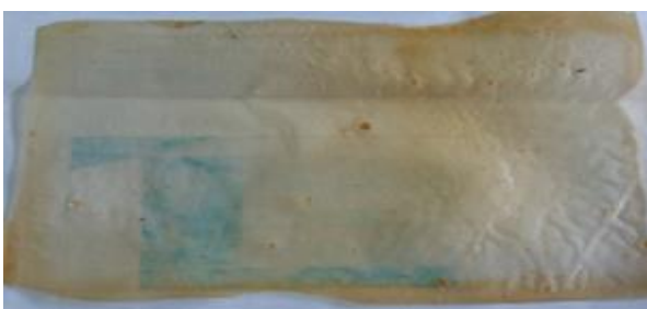
Gambar 3 Plastik biodegradable dengan massa tepung 3 gram
