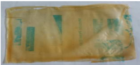
Gambar 1 Plastik biodegradable dengan massa tepung 7 gram
