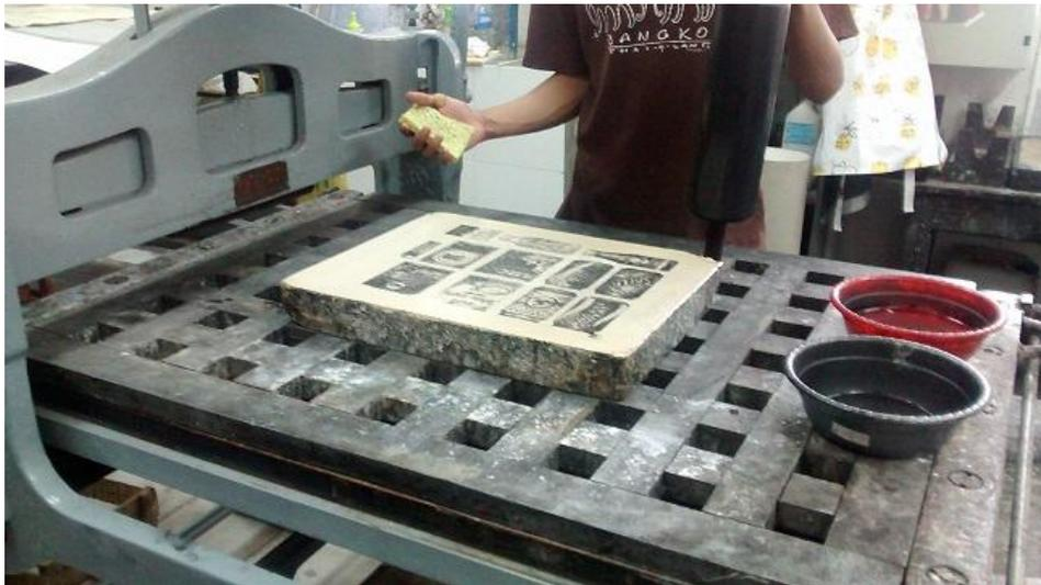
**Gambar 5.** Proses pencetakan litografi pada mesin *press*. Sumber: Dokumentasi pribadi.
