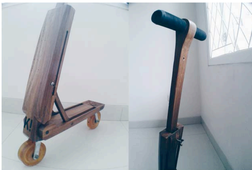
Gambar 7. Sistem engsel dan rel di bagian dalam produk(sumber: dokumen pribadi 2014)
