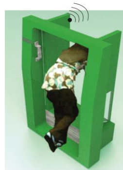
Gambar 13 Cara kerja pintu angkot (alarm dan sensor ultrasonic ). ambar 27 terjadi apabila pulsa dari penumpang tidak mencukupi untuk melakukan perjalanan atau penumpang tersebut tidak memiliki ID
