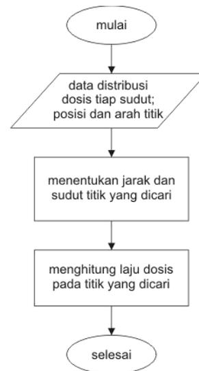
Gambar 2. Diagram alir program menggunakan kurva isodosis.
