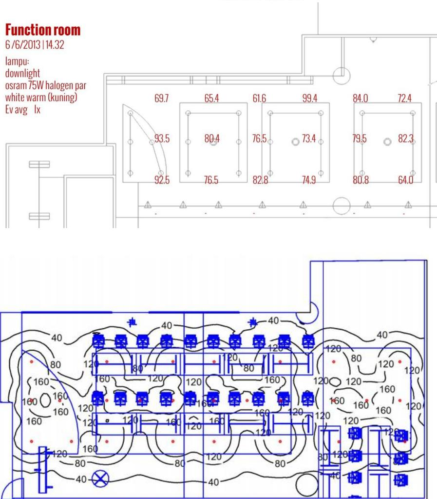
Gambar 10. Perbandingan hasil pengukuran dengan simulasi DIALux
