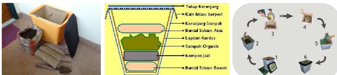
Gambar 1 Satu set, komponen serta cara pakai Keranjang Takakura
