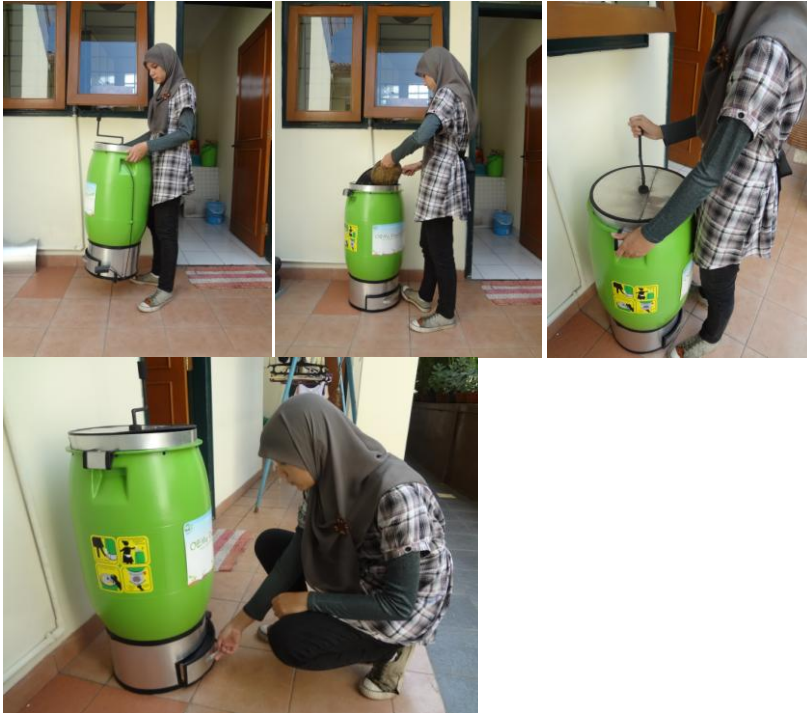
Gambar 6 Cara angkat dan pakai OEMa Reactor (masukan sampah, putar tuas, panen kompos dilaci)
