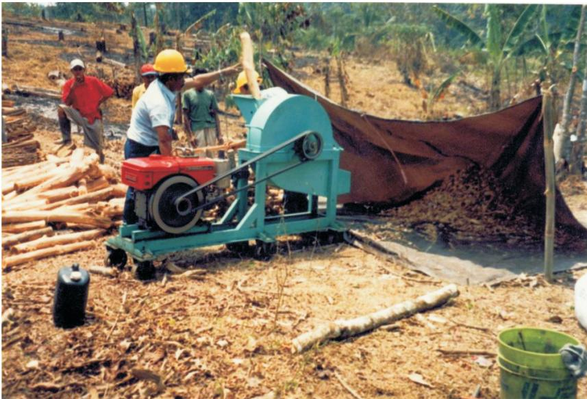
**Gambar 1. Mesin serpih mudah dipindahkan type 600**
