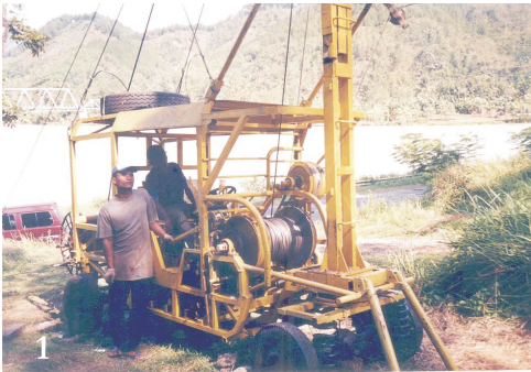
Gambar 1. Alat kabel layang P3HH24 siap dioperasikan
