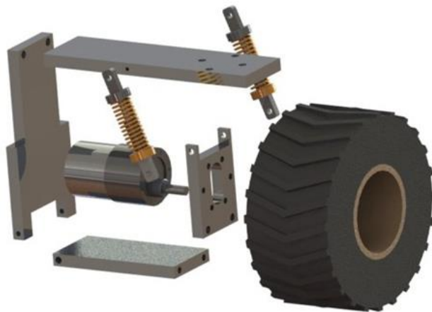
Gambar 3. Susunan rancangan suspensi dalam model CAD
