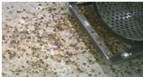
Gambar 2.12 Kulit dan biji kopi tidak terpisah di arah hembusan angin
