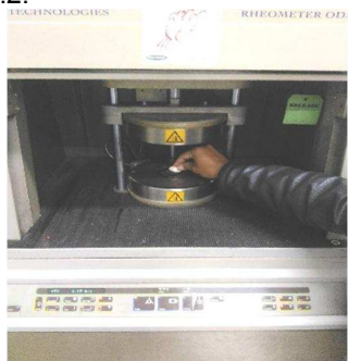
Gambar 3.2 Pengujian kompon menggunakan mesin Rheometer ODR2000
