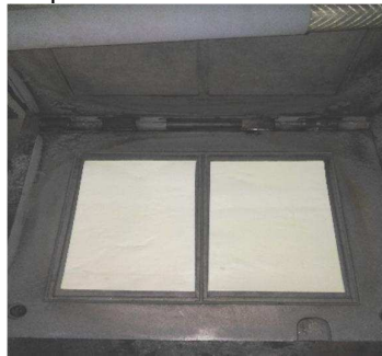
Gambar 3.6 Pemasukan kompon ke dalam cetakan
