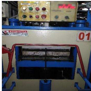
Gambar 3.7 Pemasukan cetakan ke mesin hot press
