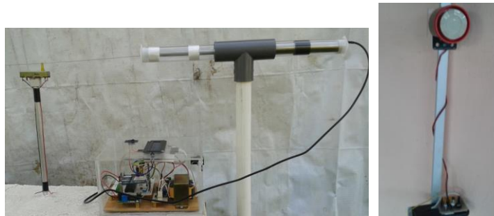
Gambar 4.5 Pengujian pengaktifan sirine
