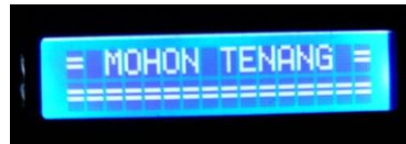
Gambar 15. Tampilan LCD dengan delay sebelum akuisisi data sinyal PPG
