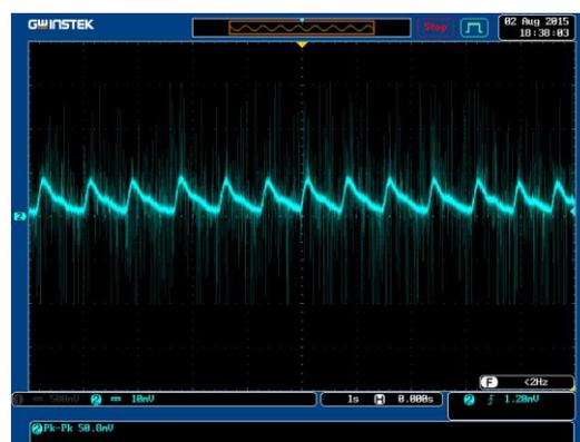
Gambar 8. Hasil Keluaran Sensor Setelah *High Pass Filter*
