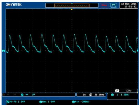
Gambar 10. Hasil Pengujian Keluaran Rangkaian Setelah *Low pass filter*
