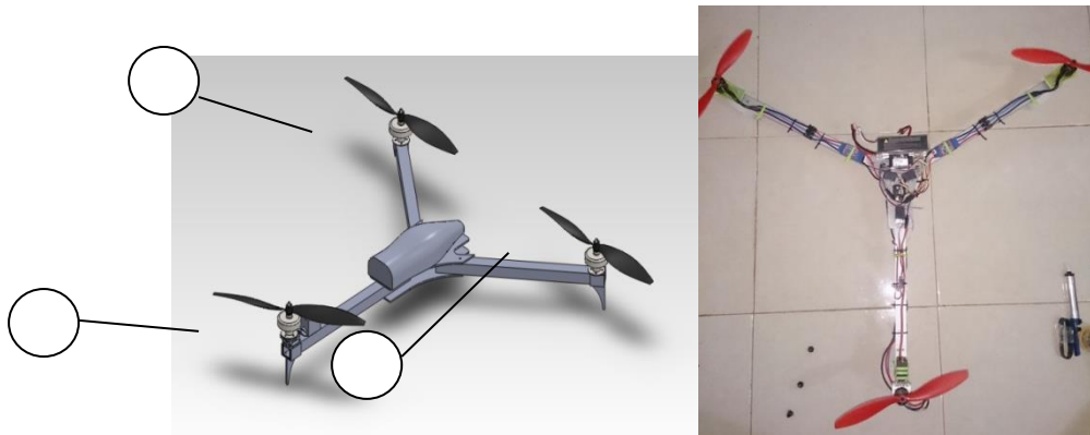
Gambar 2. Perancangan mekanik dan hasil pembuatan Tricopter
