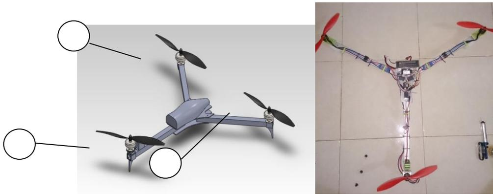
**Gambar 2. Perancangan mekanik dan hasil pembuatan Tricopter**
