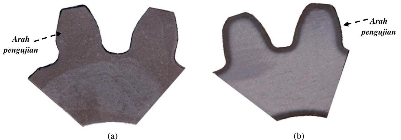
Gambar 2. Perbandingan lapisan dan kedalaman pengerasan permukaan: (a) roda gigi produk UKM dan (b) roda gigi produk industri berskala nasional
