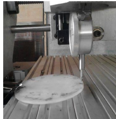
Gambar 4. Pengukuran luasan warpage dan pengukuran nilai warpage
