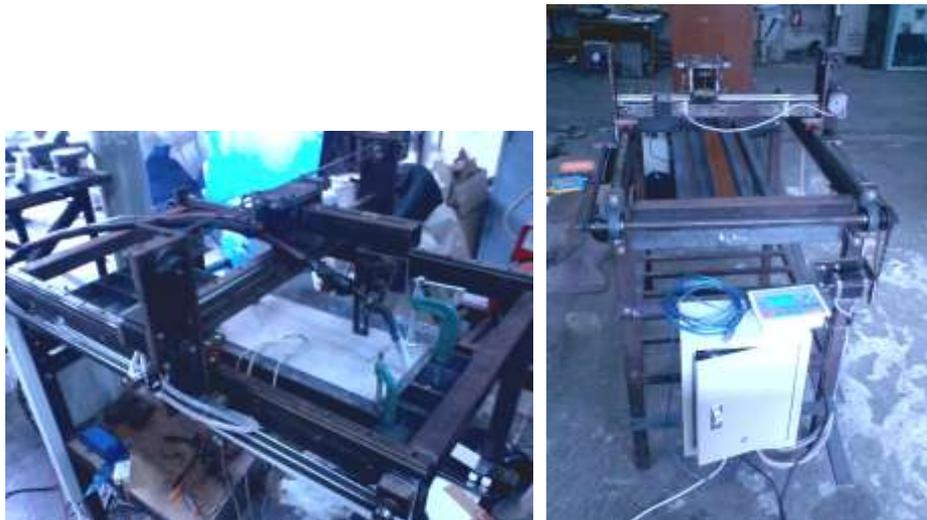
**Gambar 3. Realisasi rancang bangun sistem otomasi gerak las MIG**
