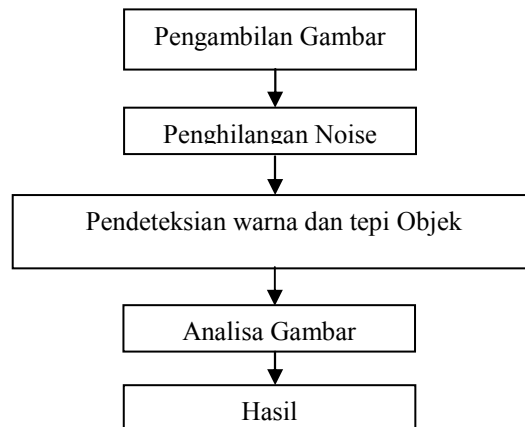
Gambar 3. Proses pengenalan citra pada mobile robot
