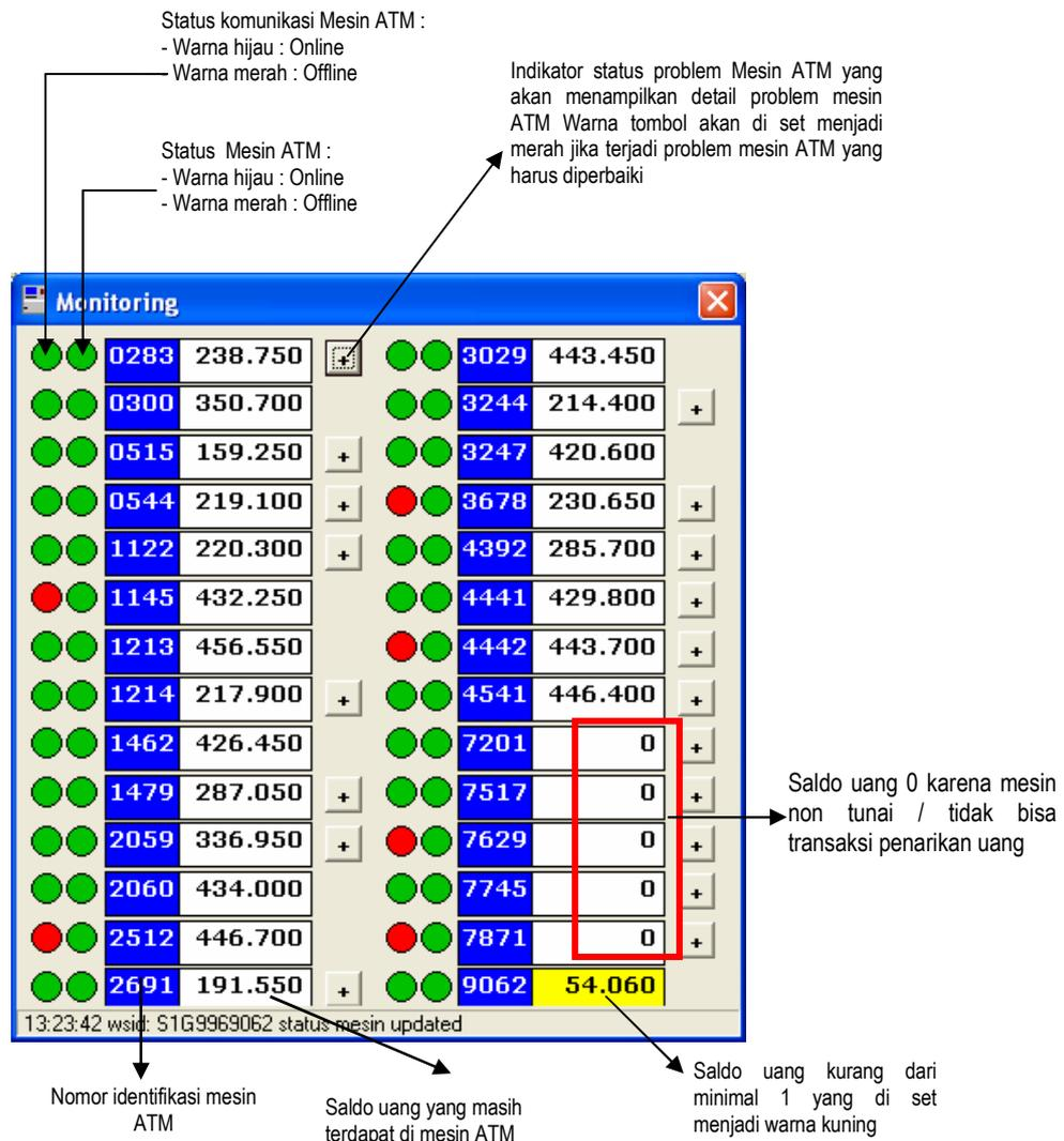
Gambar 3.5. Form Monitoring ATM yang menampilkan icon problem mesin dan komunikasi mesin ATM
