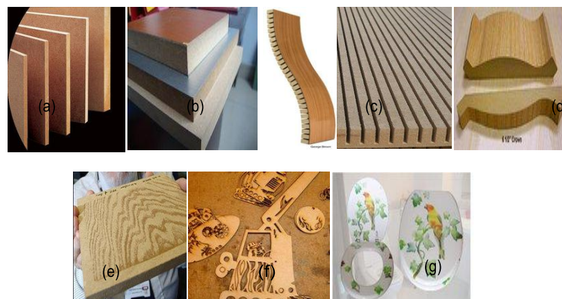
Gambar 5. Penampilan produk MDF menggunakan perekat resin formaldehid; (a) proses pembuatan, (b) plain MDF, (c) MDF fleksibel, (d) MDF moulding, (e) MDF printing, (f) MFD carved dan (g) MDF closet. (Sumber : http://learnfurniture.blogspot.com/2012/03/mdfdeskripsi-cara-pembuatan-cara.html )
