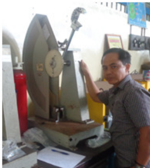
Gambar 13. Proses pengujian impact
