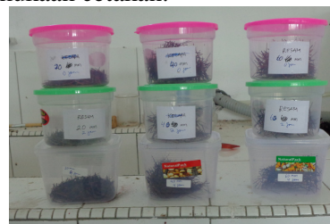
Gambar 5. Ukuran Serat Resam yang sudah direndam dengan 5% NaOH (20 mm, 40 mm dan 60 mm)
