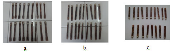
Gambar 10 a. Benda uji tarik, b. Benda uji flexure, c. Benda uji impact
