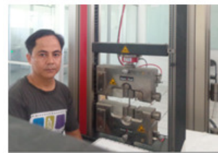
Gambar 11. Proses pengujian tarik
