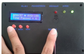
Gambar 6. Tampilan LCD saat BPM terdeteksi
