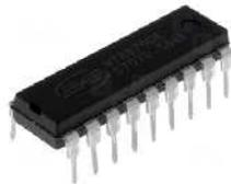
Gambar 2.2 Bentuk fisik IC DTMF [8]
