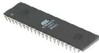
Gambar 2.1 Bentuk fisik IC ATmega 16 [6]
