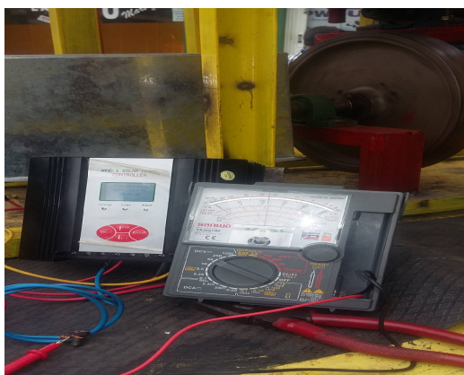
Gbr. Hasil Pengujian dengan digoyang manual, menghasilkan listrik 1,2 A 24 Volt.
