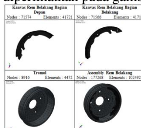
Gambar 3.3 Hasil meshing masing-masing desain komponen rem belakang.
